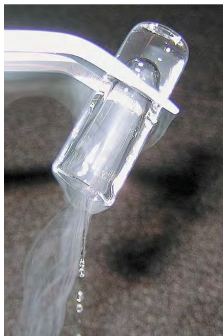
Твердый аргон плавится, вытекает из пробирки и быстро испаряется.
