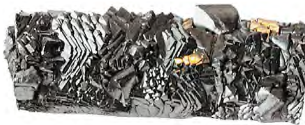
Кристалл титана, очищенного иодидным методом.
