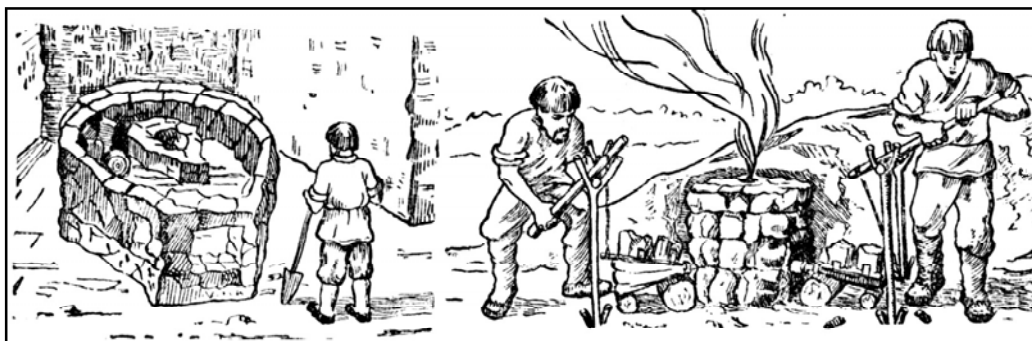
Выплавка металла из железной руды сыродутным способом в VIII–IX вв.
