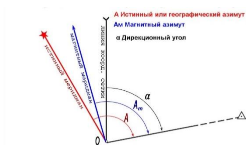
Рис. 1. Углы применяемые в топографии
