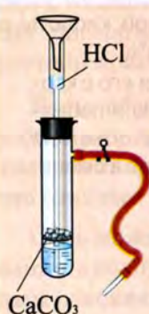
Рис. 30. Прибор для получения углекислого газа
